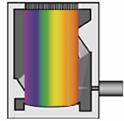
d Fra hulspejlet sendes lyset over mod CCD-arrayet. Her dannes de signaler, som computerprogrammet skal behandle.
